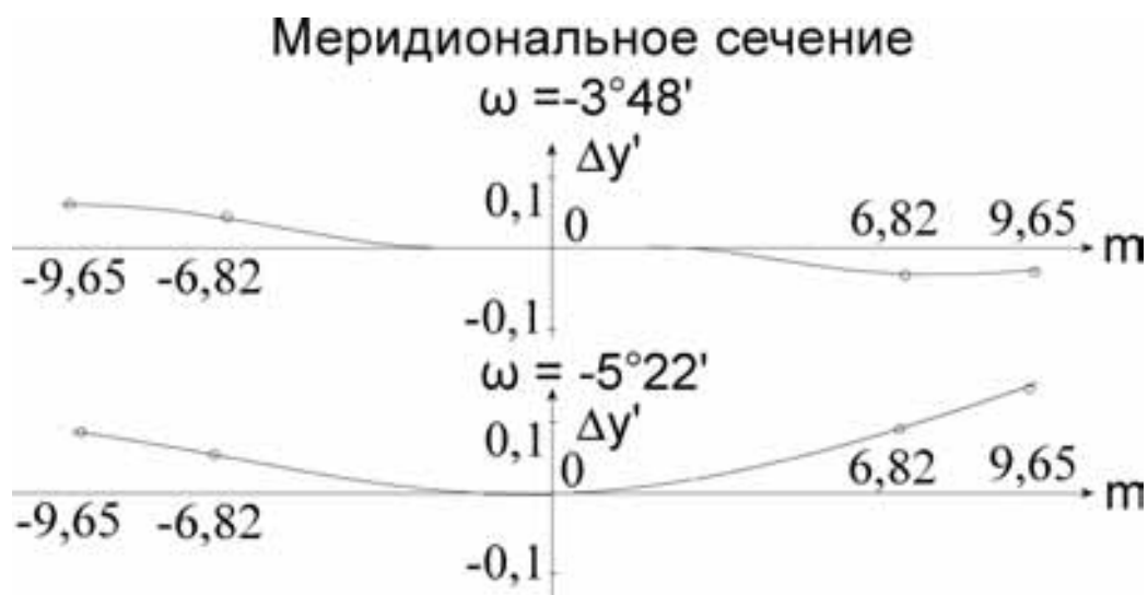
Рисунок 5.3. Пример построения графиков поперечных aberrаций широкого меридионального пучка лучей.
