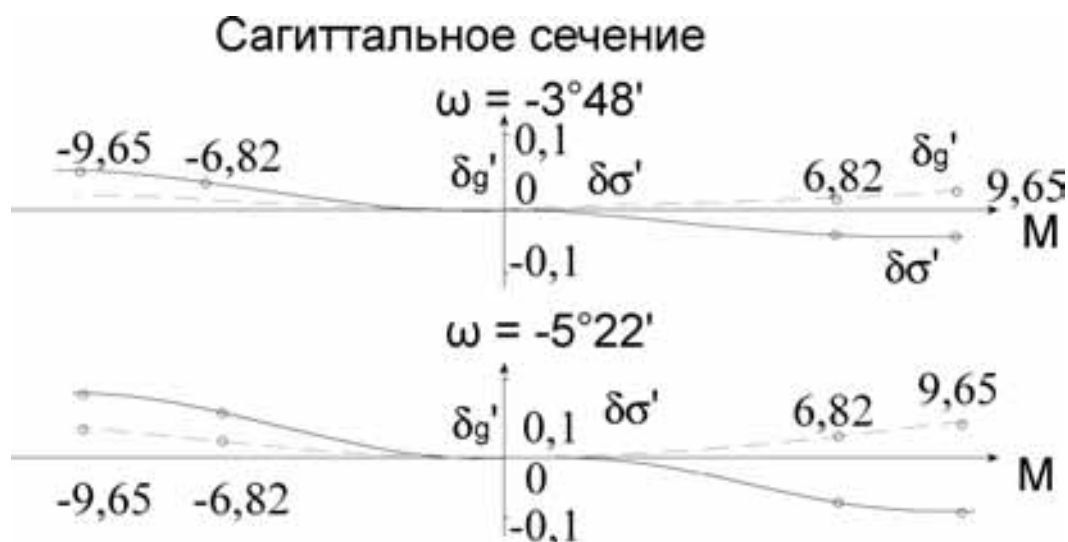
Рисунок 5.4. Пример построения графиков поперечных aberrаций широкого сагиттального пучка лучей.
