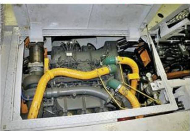
Экономичный двигатель фирмы DEUTZ TCD 2015 мощностью 330 кВт с электронной системой управления и диагностики.
