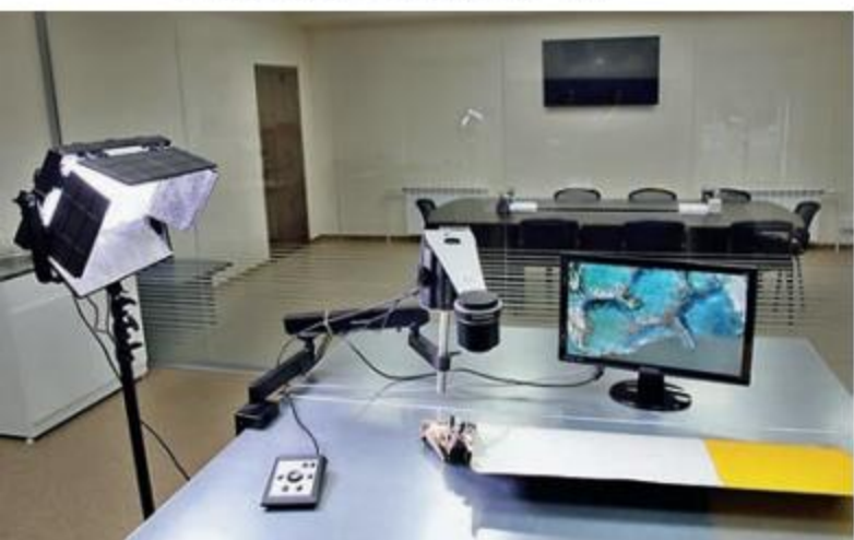
Рис. 4. Цифровой оптический микроскоп при исследовании фрагментов ВС
