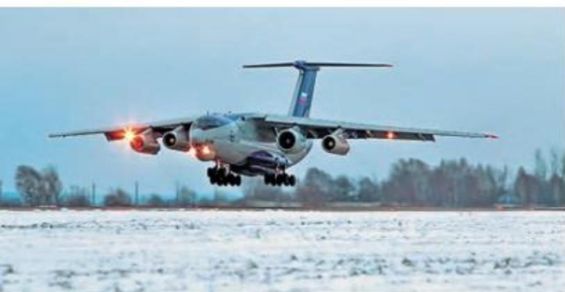
В ходе летных испытаний двигателя ПД-14 на крыле летающей лаборатории Ил-76ЛЛ
