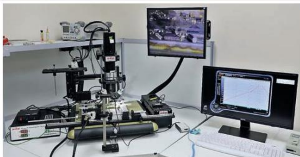
Рис. 10. Ремонтный центр с технологией сфокусированного ИК-нагрева
