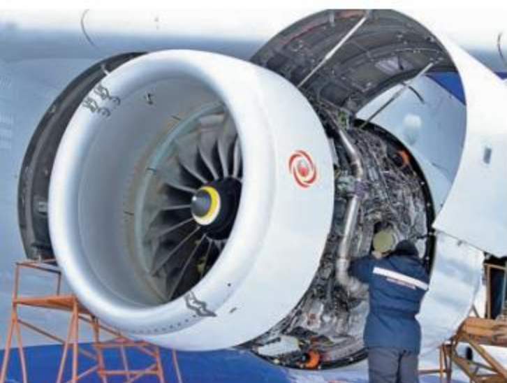
Двигатель ПД-14 на крыле летящей лаборатории Ил-76ЛЛ
