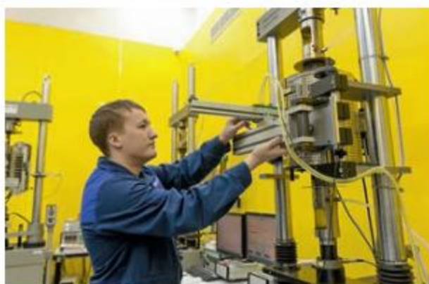
На участке исследования малоциклового усталости новейших авиационных материалов АО «ОДК-Авиадвигатель»
