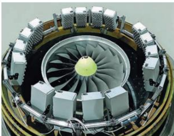
Испытания стойкости вентилятора ПД-14 к попаданию крупной одиночной птицы на разгонном стенде
