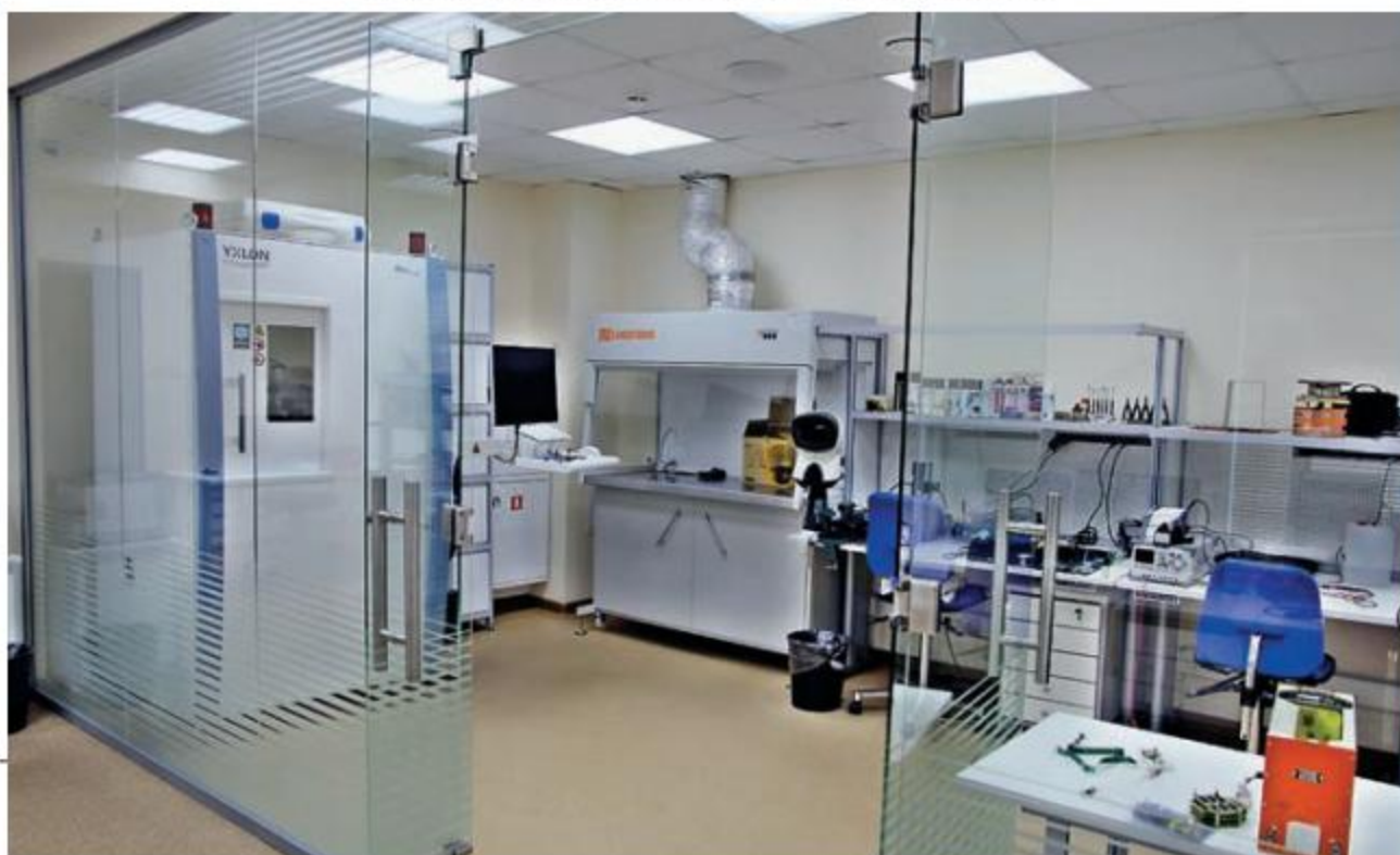
Рис. 6. Зона с электростатической защитой для работы с микросистемными компонентами
