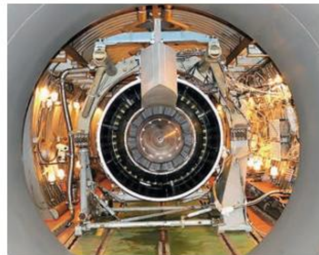
Во время испытаний ПД-14 по оценке отсутствия автоколебаний лопаток вентилятора и спрямляющего аппарата
